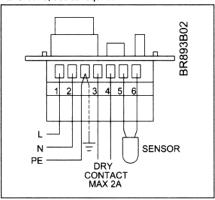
Fig. 2 - with built-in sensor / avec capteur incorporé PE: Ground, use as required
